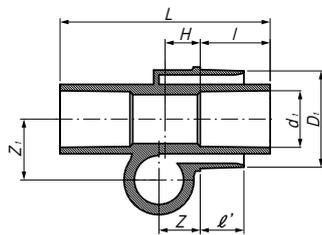
接合部形状：内管部はTS受口タイプです。外管部はパイプ内面への挿入タイプです。
