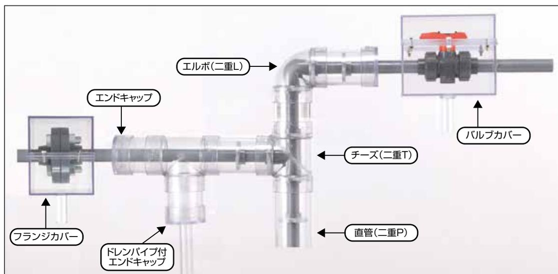
注) エンドキャップ・フランジカバー・バルブカバーの内管貫通部、接合部には隙間があります。これらの製品は、飛散防止用で止水性はありません。従って、シーリング材等にて隙間を埋めてください。また、カバー内が薬液より水圧が加わらない様、ドレン配管をしてください。内圧でカバーが破損し、薬液やカバー破片が飛散する危険があります。シーリング材を侵す薬液がありますので、内管が漏水して薬液が接触した場合は、隙間を埋めて再度やり直してください。シール剤には、可塑剤を含有し、塩ビ管を侵すものがありますので、メーカーにご確認の上、使用願います。バルブおよびフランジカバーは荷重が管に加わるため、架台を設置してください。特注品として、フランジカバー、バルブカバーを製作できますので、お問合せください。
