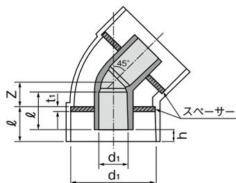
透明の外継手45DLは呼び径50,65,75,100のみとなります。
